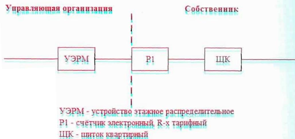
Управляющая организация и собственник несут ответственность за надлежащее состояние и работоспособность питающих электрических сетей на квартиру согласно вышеуказанной схеме до прибора учета (пунктирной линии слева).
